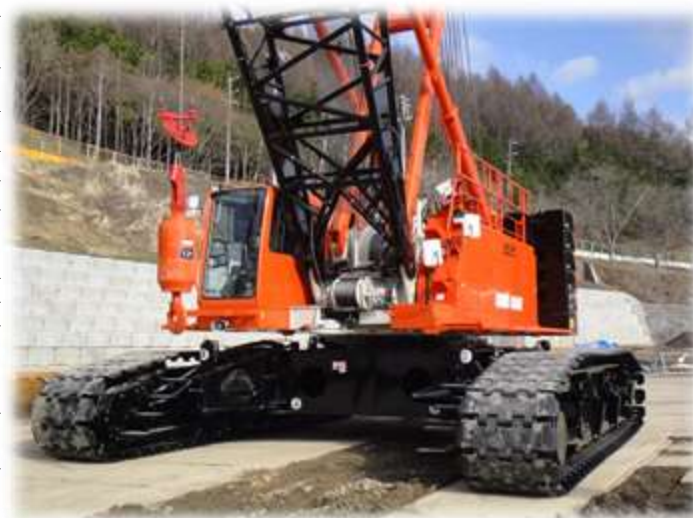
工事用クレーン 2号機完成(120t吊)
